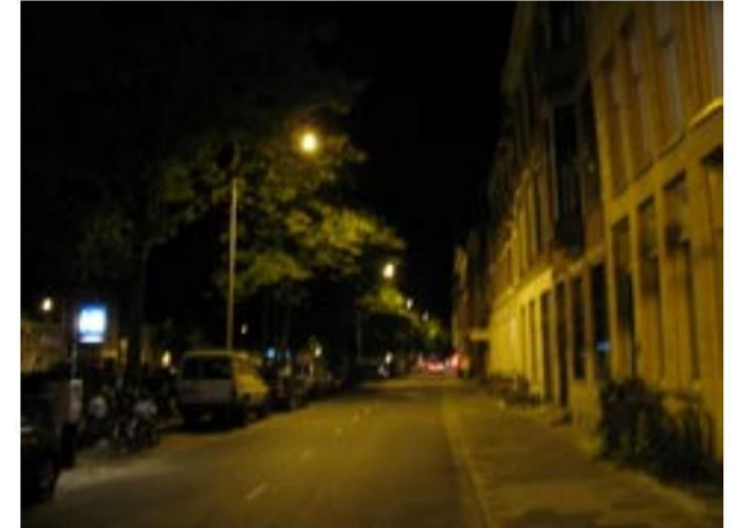
De natriumlamp zorgt voor een sfeervoller beeld. Doordat het armatuur vrij hoog hangt, worden de gevel en de bomen gedeeltelijk aangelicht, wat zorgt voor een prettig en overzichtelijk beeld.
